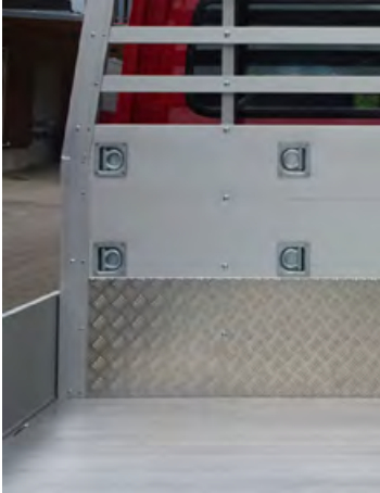
Binderingen an Stirnwand
